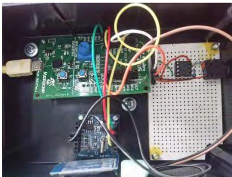
Figura 5. Dispositivo electrónico medidor de energía eléctrica.
