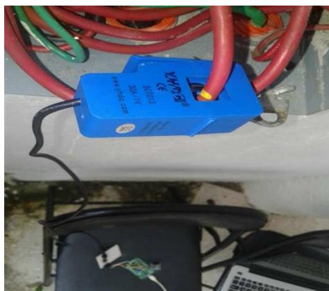
Figura 1. Sensor de corriente analógico no invasivo
