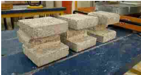
Figura 3. Adoquines unidos con mortero testigo y sustituidos.
