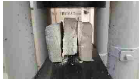
Figura 4. Ensaye de prueba de esfuerzo cortante
